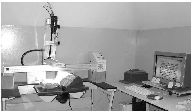
Le scanner des archives est un DIGIBOOK 6002RGB pouvant numériser des documents jusqu'à un format de 85 x 60 cm à une résolution de 250 dpi.
