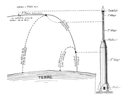
Une fusée à plusieurs étages, habituellement trois, amène le satellite sur son orbite. Le schéma ci-dessus explique les différentes phases propulsives. suivant la loi de gravitation des astres, tourne-t-il autour de la terre en décrivant une ellipse plus ou moins allongée. Contrairement à l'idée que gardent encore quelques profanes, le satellite n'échappe pas à la pesanteur. C'est elle qui le maintient sur l'orbite, l'empêchant de s'enfuir dans les espaces lointains.
